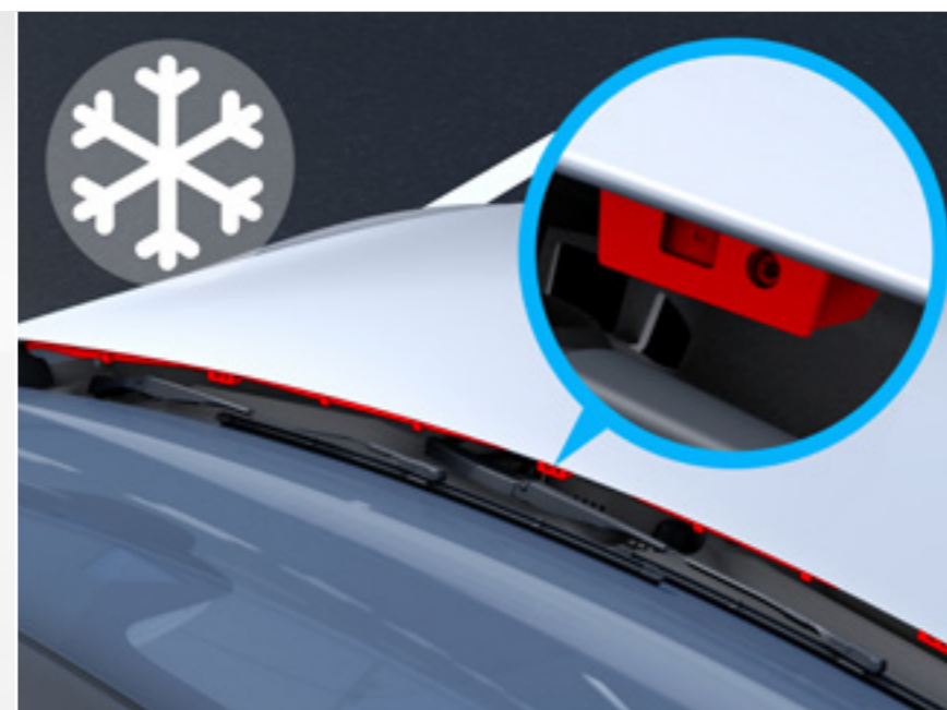
Sistema di lavaggio del parabrezza riscaldato (875)
