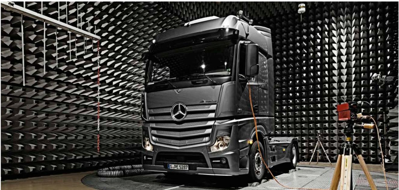
Verifica della compatibilità elettromagnetica in un padiglione appositamente schermato dalle interferenze elettromagnetiche esterne.
