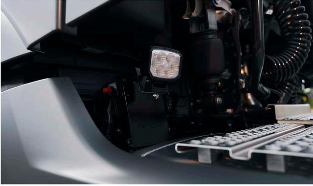
I fari di lavoro a LED supplementari montati sul retro della cabina di guida consentono di lavorare in sicurezza grazie a una buona illuminazione, anche in condizioni di scarsa luminosità (oscurità, crepuscolo, nebbia, ecc.). Inoltre migliorano la visibilità al buio accanto alla cabina di guida, ottimizzando così le prestazioni della mirror cam.
