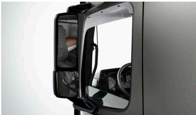
Senza turbolenze: deflettore per il finestrino laterale per guidare senza correnti d'aria anche a finestrino aperto. Con apertura precisa per lo specchio guardaruota sul lato passeggero.
