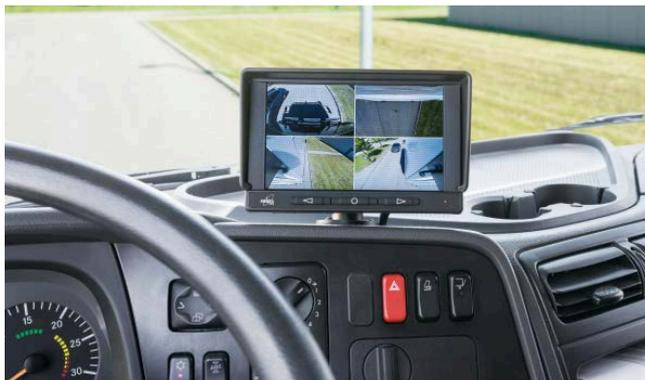
Per un controllo a 360 gradi: questo monitor TFT da 7" con retroilluminazione LED di alta qualità e un'eccellente qualità dell'immagine è stato concepito appositamente per l'utilizzo nei veicoli industriali e offre i vantaggi di una visualizzazione Surround View perfetta.
