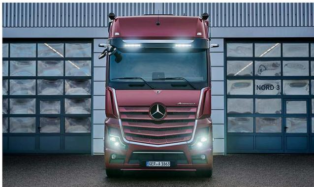
Le barre a LED per l'aletta parasole uniscono molti vantaggi in due fari: Le barre a LED coniugano l'innovativa tecnologia con l'inconfondibile design dell'Actros. Si integrano in modo discreto nell'aletta parasole e offrono quindi una potenza luminosa supplementare con una resistenza aerodinamica inferiore rispetto a una tradizionale staffa di supporto dei fari supplementari.
