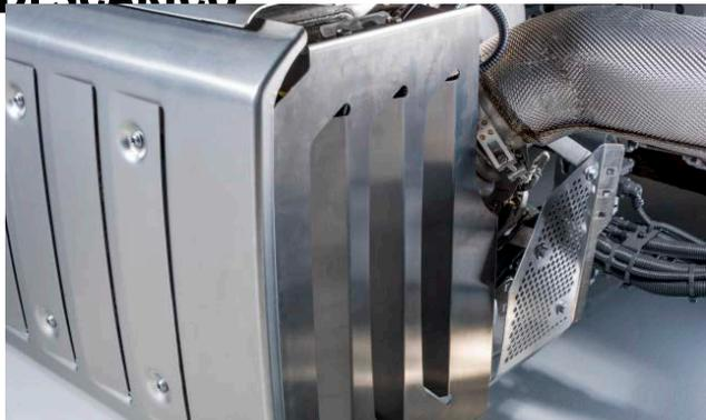
Il lato frontale della scatola di post-trattamento dei gas scarico per il motore 47X può essere equipaggiato con una lamiera di schermatura di costo contenuto. In particolare, per il duro impiego in cantiere e nei veicoli con uno spazio libero per i piedi d'appoggio della gru (C7Q, JC7Q) è possibile diminuire l'imbrattamento dei componenti elettronici della scatola di post-trattamento dei gas di scarico.
