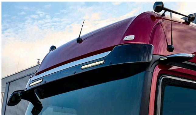
Le barre a LED per l'aletta parasole uniscono molti vantaggi in due fari: Le barre a LED coniugano l'innovativa tecnologia con l'inconfondibile design dell'Actros. Si integrano in modo discreto nell'aletta parasole e offrono quindi una potenza luminosa supplementare con una resistenza aerodinamica inferiore rispetto a una tradizionale staffa di supporto dei fari supplementari.
