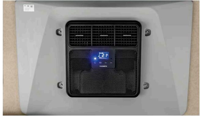
Für mehr Komfort und Wohlbefinden an heißen Tagen: Die leistungsfähige Dachklimaanlage für den Standbetrieb (bis zu 12 h Betriebszeit) kühlt motorunabhängig die Innenraumluft. Sie wird in der vorhandenen Dachluke mit maximalem Aufstellwinkel von 8° montiert.
