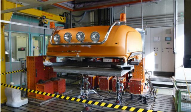
Hydropulsprüfstand zur Simulation von Schlaglöchern und schlechten Straßen.
