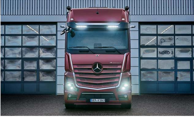
Die LED-Bars für die Sonnenblende vereinen viele Vorteile in zwei Scheinwerfern: Die LED-Bars verbinden die innovative Technologie mit dem unverwechselbaren Design des Actros. Sie schmiegen sich unauffällig in die Sonnenblende ein und bieten somit zusätzliche Lichtleistung bei weniger Luftwiderstand als bei einem herkömmlichen Dachlampenbügel.
