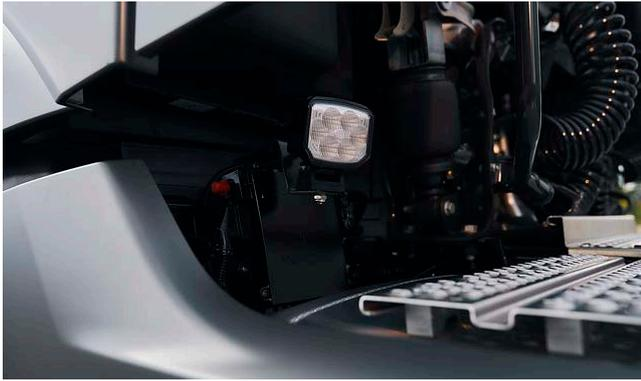
Die zusätzlichen an der Rückseite des Fahrerhauses montierten LED-Arbeitsscheinwerfer ermöglichen sicheres Arbeiten durch gute Beleuchtung, auch bei schlechten Lichtverhältnissen (Dunkelheit, Dämmerheit, Nebel etc.). Zudem verbessern sie die Sicht bei Dunkelheit neben dem Fahrerhaus, wodurch die Leistung der MirrorCam optimiert wird.
