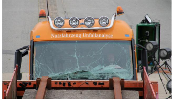
Prüfung auf Biegen und Brechen: Dachlampenbügel im Crashtest.
