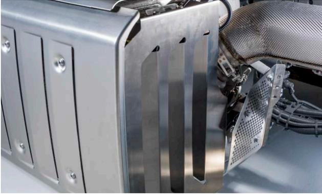
Die Stirnseite der Abgasbox beim Motor 47X kann kostengünstig mit einem Abschirmblech nachgerüstet werden.
