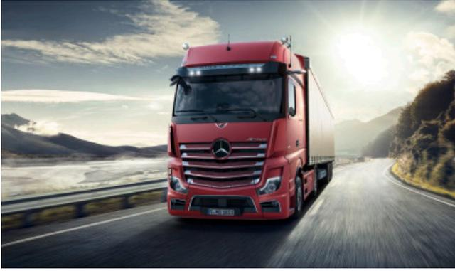
Die vier zusätzlichen runden Fernscheinwerfer mit moderner, energieeffizienter LED-Technik für die Sonnenblende vereinen Design und Technik. Sie bieten eine tageslichtähnliche Ausleuchtung, so wird die Sicht für den Fahrer wesentlich unterstützt. Durch die Integration der Scheinwerfer in die Sonnenblende ist ein Vorteil in Aerodynamik und Gewicht messbar (gegenüber einem Dachlampenbügel mit Zusatzscheinwerfern). Es sind keine weiteren Befestigungspunkte am Dach notwendig.
