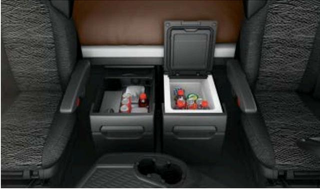
Auch unterwegs sehr gut gelagert: Der Kühlschrank in der Schublade unter dem Bett sorgt für geeignete Kühltemperaturen für Getränke und Lebensmittel. Er wird über einen Schalter an der Instrumententafel aktiviert. Die Kühlleistung ist, unabhängig von der Umgebungstemperatur, über einen Thermostat regelbar.
