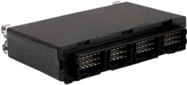
Das programmierbare Sondermodul dient als Kommunikations-Schnittstelle zwischen Fahrzeug und Aufbau und ermöglicht dadurch ein einfacheres und effizienteres Handling. Dabei kann ein direkter Informationsaustausch zwischen Fahrzeugelektronik und Ein-, An- und Aufbauten sowie Anhänger/Auflieger durch Vernetzung über CAN-Bus erfolgen. So wird eine hohe Funktionssicherheit aller Komponenten gewährleistet, da das nachträgliche Andocken ohne Eingriffe an der Fahrzeugelektrik und -elektronik erfolgt.
