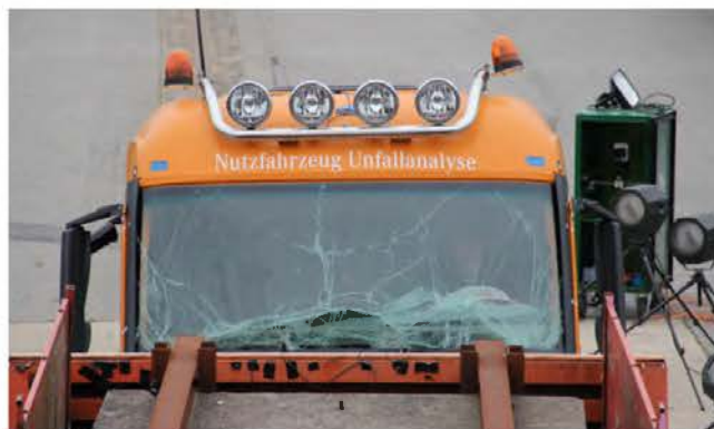
Déformation et rupture contrôlées : le support pour lampes de toit à l'épreuve du crash test.
