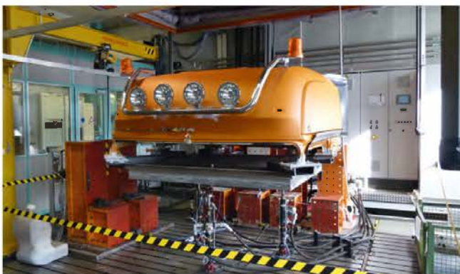
Banc d'essai à hydropulseur servant à simuler des nids-de-poule et des routes dégradées.
