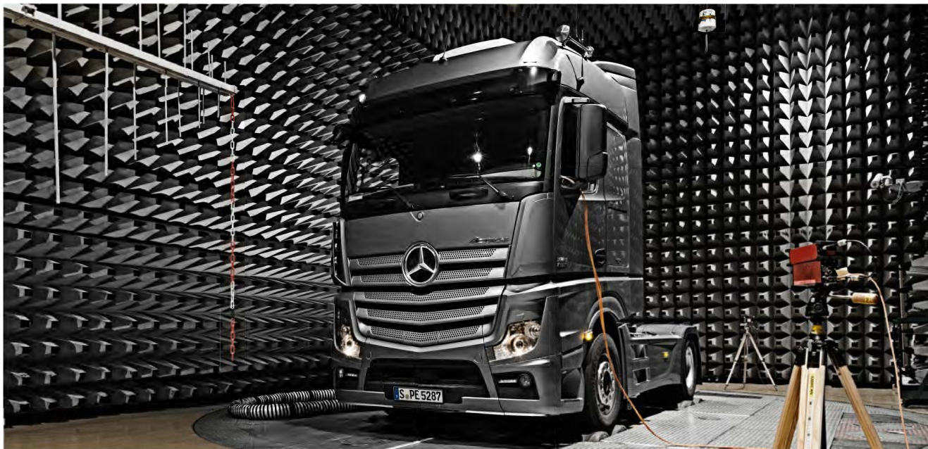
Contrôle CEM dans une salle spécialement protégée contre les perturbations électromagnétiques extérieures.
